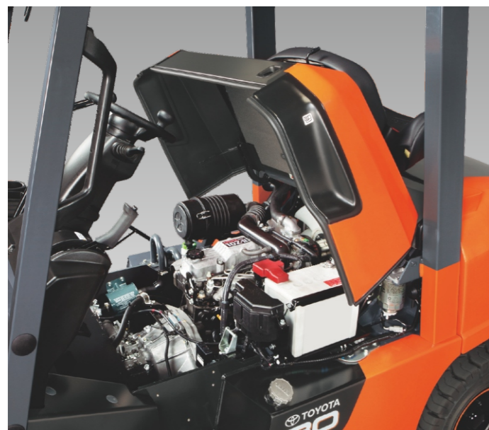
可掀起近90度的引擎蓋設計，讓日常保養及維護作業更加有效率。
